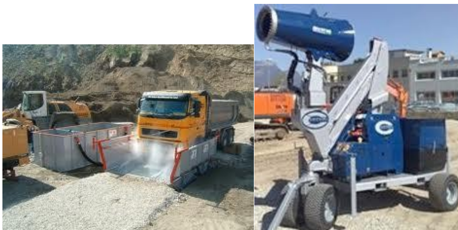
Figura 59 - Cannone nebulizzatore - Impianto lavaggio gomme
